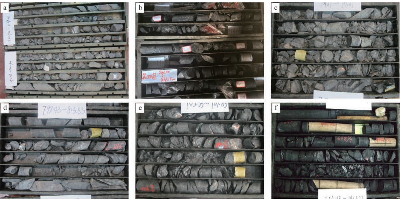
图 4 渝东南页岩气钻井岩心上顺层滑脱变形域特征
